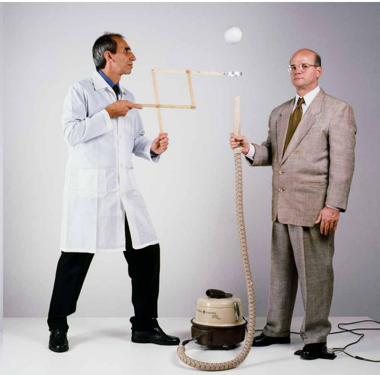
Levitação da esfera com aspirador de pó e captura com braço pantográfico.
