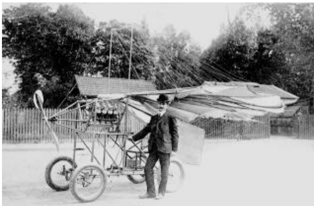
La machine de Voia à moteur Antoinette 50 ch, 1903-1906. Notez que l'aile n'est qu'un plan incliné.
