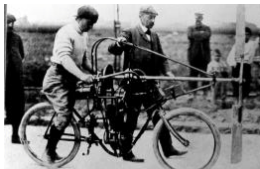
Archdeacon et Anzani procèdent à des essais de traction d'hélices, une expertise que Santos-Dumont possède depuis deux ans. (L'Illustration).
