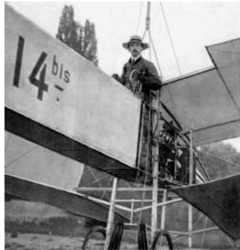
Santos-Dumont ayant suspendu son biplan sous l'enveloppe de son dirigeable n° 14 pendant ses essais en août 1906 baptisa cette dernière machine 14bis.
